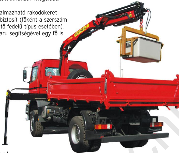
A szerszám nélkül eltávolítható fedél leszerelése után a rakodókeret könnyedén használható (a képen a 700 l-es tároló)
