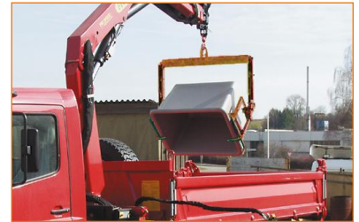
A síkosságmentesítő anyag tároló edény ürítése teherautó platóra. (a képen a 700 l-es tároló)
