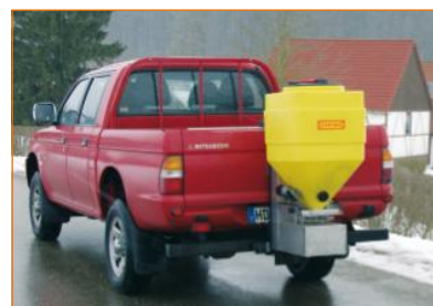
ES 105 típus: példa a hátfalra akasztott (só)szóróhoz
