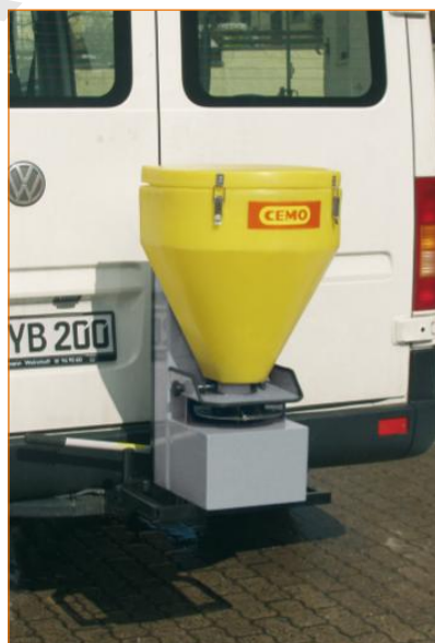
ES 45 típus: példa a vonóhorogra akasztott (só)szóróhoz
